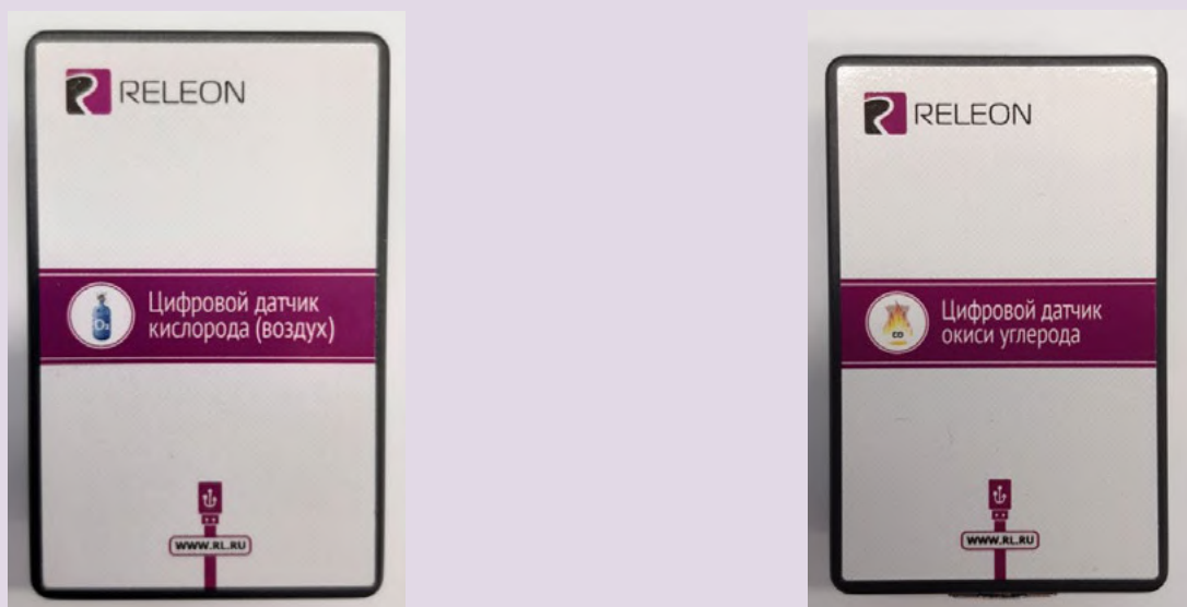
Рис. 11. Датчики кислорода (слева) и угарного газа (справа)
